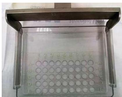
Figura 5. Plato de compresión perforado Siemens Healthcare.
